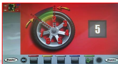
Program SPOKE (ukrycie ciężarków za ramionami felgi).
