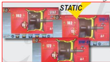
STATIC Tryb wyważania kół motocyklowych.
